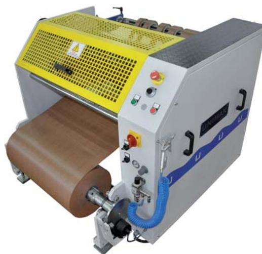
Простота в использовании, высокое качество нарезки и намотки пленки являются их характерными свойствами. Легко настраиваемые режущие инструменты (лезвия) прослужат долго благодаря двухстороннему использованию. Они доступны для замены на рынке и не требуют таких финансовых затрат, как дисковые ножи.
