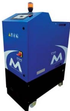
ления оборудования «Мелтон» устанавливается температура в 3-х точках: в емкости, шланге и дюзе. Температура плавления зависит от марки и производителя клея и изменяется от 110 до 145 градусов.
