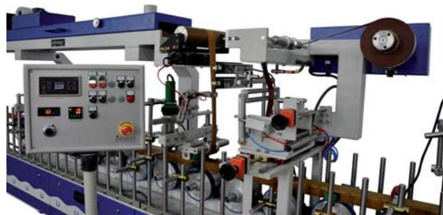
Рабочая длина станка (5 м) имеет достаточное пространство для деионизации и сдува пыли, а также нанесения праймера на поверхность профиля и ее тщательной осушки. Оптическая система слежения предотвращает сдвиг пленки и удерживает ее строго в настроенной точке.
