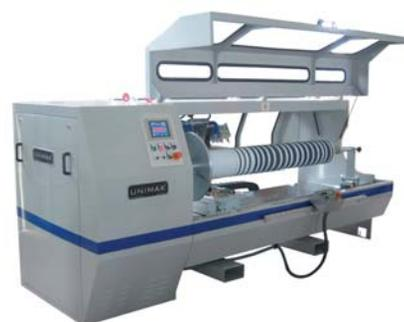
ному производству оборудования, погрешность нарезки составляет всего 0,1 мм.
