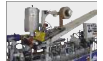
EVA / PO HOTMELT TUTKAL UYGULAMA SİSTEMİ EVA / PO HOTMELT GLUE APPLICATION SYSTEM СИСТЕМА НАНЕСЕНИЯ ТЕРМО- ПЛАВКОГО КЛЕЯ ЭВА / ПО
