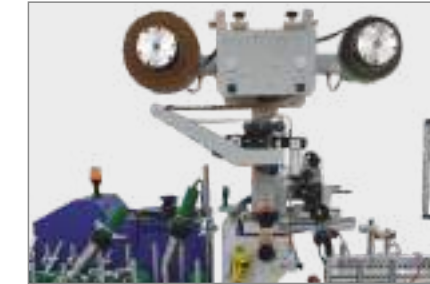
2- AFS OTOMATİK FOLYO EKLEME MODÜLÜ AUTOMATIC FOIL ADDING MODULE СИСТЕМА АВТОМАТИЧЕСКОЙ ЗАМЕНЫ РУЛОНОВ
