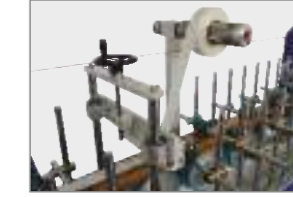
KORUYUCU BANT KAPLAMA İSTASYONU
