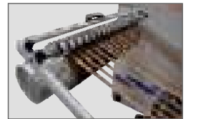
GERGİ KONTROLLÜ FRIKSİYON ŞAFT TENSION CONTROLLED FRICTION SHAFT ФРИКЦИОННЫЙ ВАЛ С РЕГУЛИРОВКОЙ ТЯГИ ПЛЕНКИ
