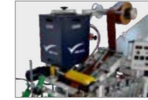
POLİÜRETAN (PUR), EVA / PO HOTMELT TUTKAL ERİTME KAZANI (VMM) POLYURETHANE (PUR), EVA / PO HOTMELT MELTING UNIT (VMM) КЛЕЕВОЙ БАК (VMM) ДЛЯ ПЛАВЛЕНИЯ ТЕРМОПЛАВКОГО ПОЛИУРЕТАНА (ПУР) И ЭВА / ПО
