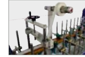
KORUYUCU BANT KAPLAMA İSTASYONU PROTECTIVE TAPE WRAPPING STATION
