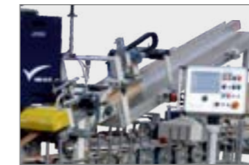
SERVO MOTOR VE ENKODERLİ ALT - ÜST PROFİLLER ARASINDA SENKRONİZASYON SAĞLAYAN OTOMATİK ÜST ÇİTA BESLEME ÜNİTESİ AUTOMATIC TOP LATH FEEDER, SYNCHRONIZATION BETWEEN TOP AND BOTTOM LATH PROVIDED BY SERVO MOTOR AND ENCODER УЗЕЛ АВТОМАТИЧЕСКОЙ ПОДАЧИ ВЕРХНЕЙ ПЛАНКИ, ОБЕСПЕЧИВАЕТ СИНХРОНИЗАЦИЮ МЕЖДУ ВЕРХНЕЙ И НИЖНЕЙ ДОСКИ ПРИ ПОМОЩИ СЕРВОДИВИТЕЛЯ И ЭНКОДЕРА
