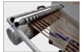
GERGİ KONTROLLÜ FRIKSİYON ŞAFT TENSION CONTROLLED FRICTION SHAFT ФРИКЦИОННЫЙ ВАЛ С РЕГУЛИРОВКОЙ ТЯГИ ПЛЕНКИ
