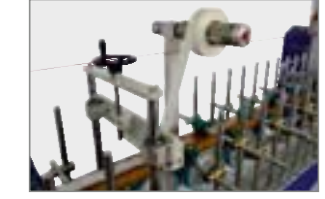
KORUYUCU BANT KAPLAMA İSTASYONU PROTECTIVE TAPE WRAPPING STATION УЗЕЛ НАНЕСЕНИЯ ЗАЩИТНОЙ ПЛЕНКИ
